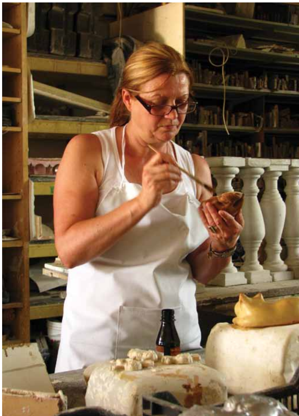
Nakładanie powłok na odlew sztukatorski
