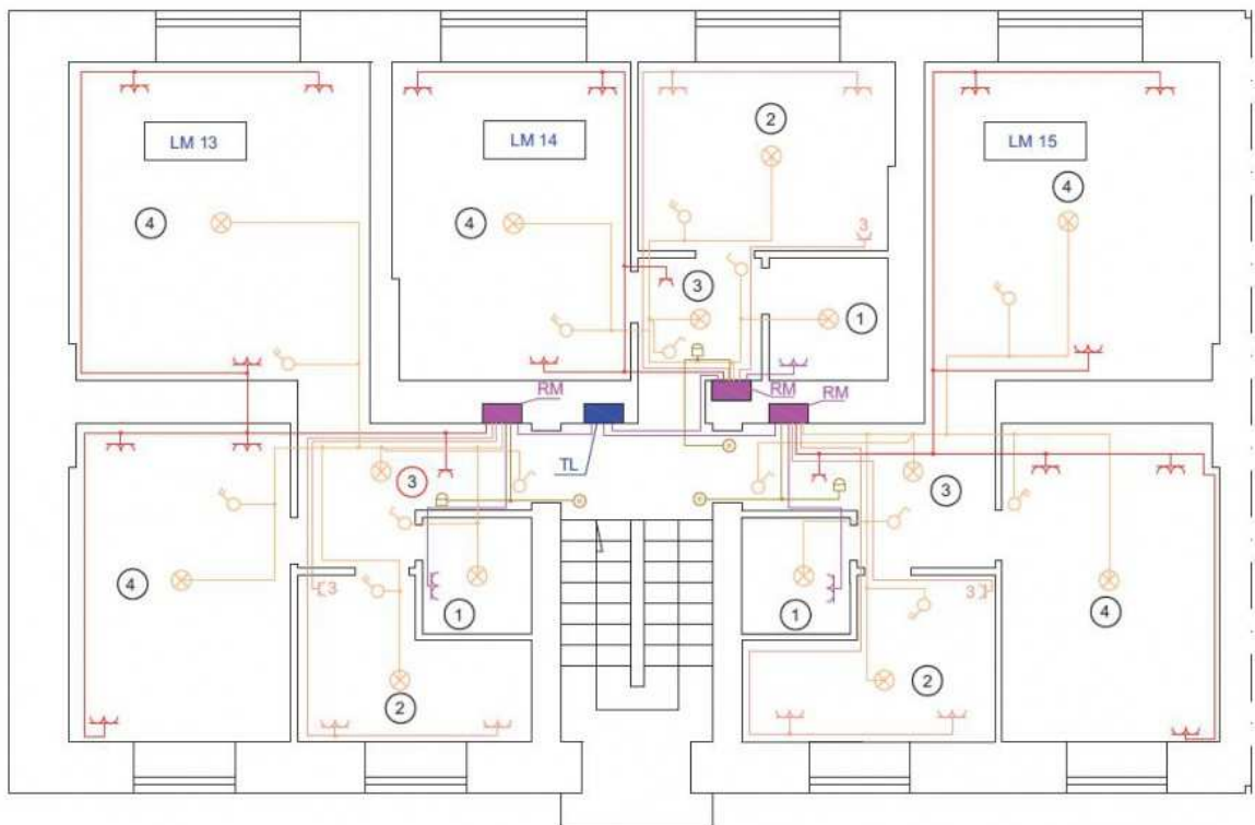
Rys. 4. Plan instalacji elektrycznej w lokalu mieszkalnym.
