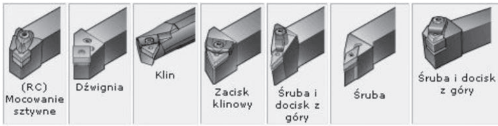
Rys. 8. Systemy mocowania płytek noży tokarskich.
