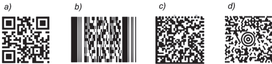
Rys. 1.1. Przykłady dwuwymiarowych kodów kreskowych [39]: a) QR Code firmy DENSO (Japonia), b) PDF417 firmy Symbol Technologies (USA), c) DataMatrix firmy RVSI Acuity CiMatrix (USA), d) Maxi Code firmy UPS (USA).
