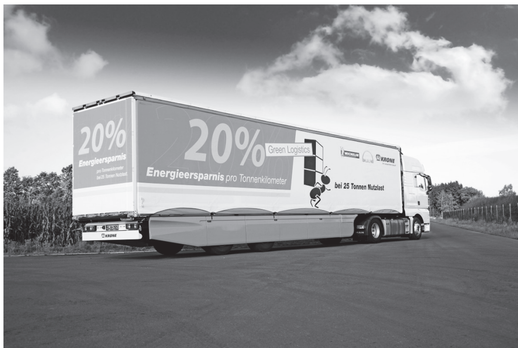
Rys. 9.6. Zestaw drogowy 38 – tonowy firm Man, Michelin z energooszczędną naczepą siodłową firmy Krone [34].
