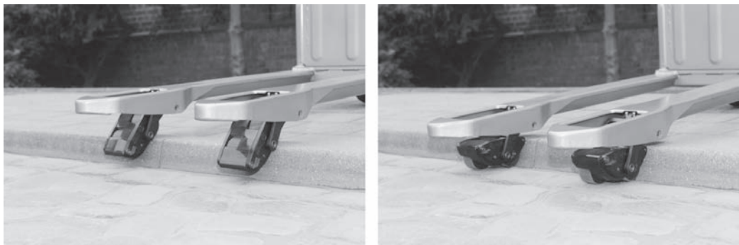
Rys.2.5. System rolek wózka CiTi One ułatwiający pokonywanie nierówności terenu.
