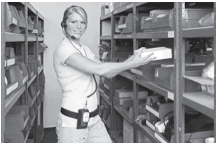
Rys. 3.1. Zastosowanie terminalu Wi-Fi z zestawem mikrofonowo-słuchawkowym firmy topsystem w procesie komisjonowania [36].
