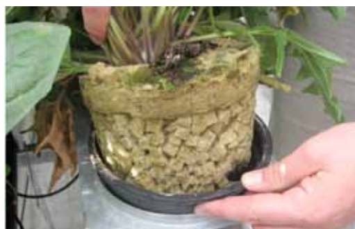
Fot. 6. Granulowana wełna mineralna (fot. Jacek Nowak)
