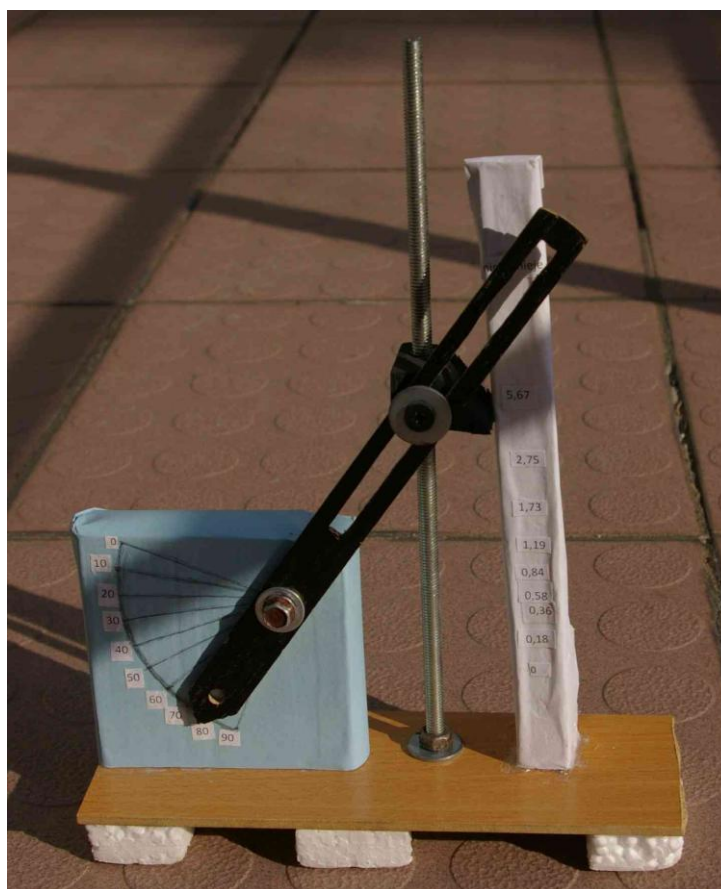
Rys. 8. Analogowy „tangensomierz” skonstruowany na podstawie schematu z rys. 7 wykonany przez studentkę Wydziału Matematyki, Informatyki i Mechaniki Uniwersytetu Warszawskiego.
