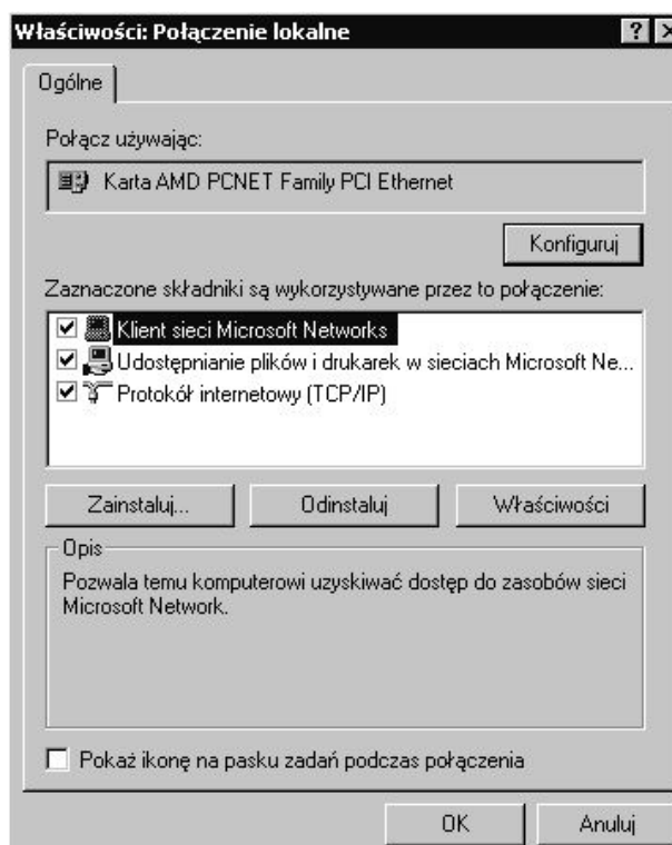
Rysunek 45 Właściwości połączeń lokalnych
