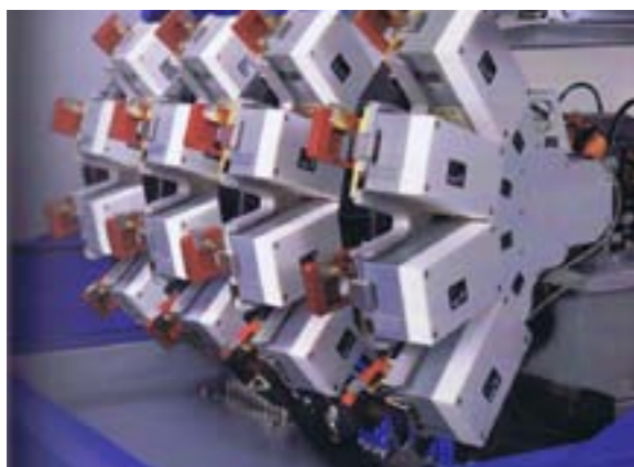
Rys. 7.18 Lasery dyskowe połączone w zestaw
