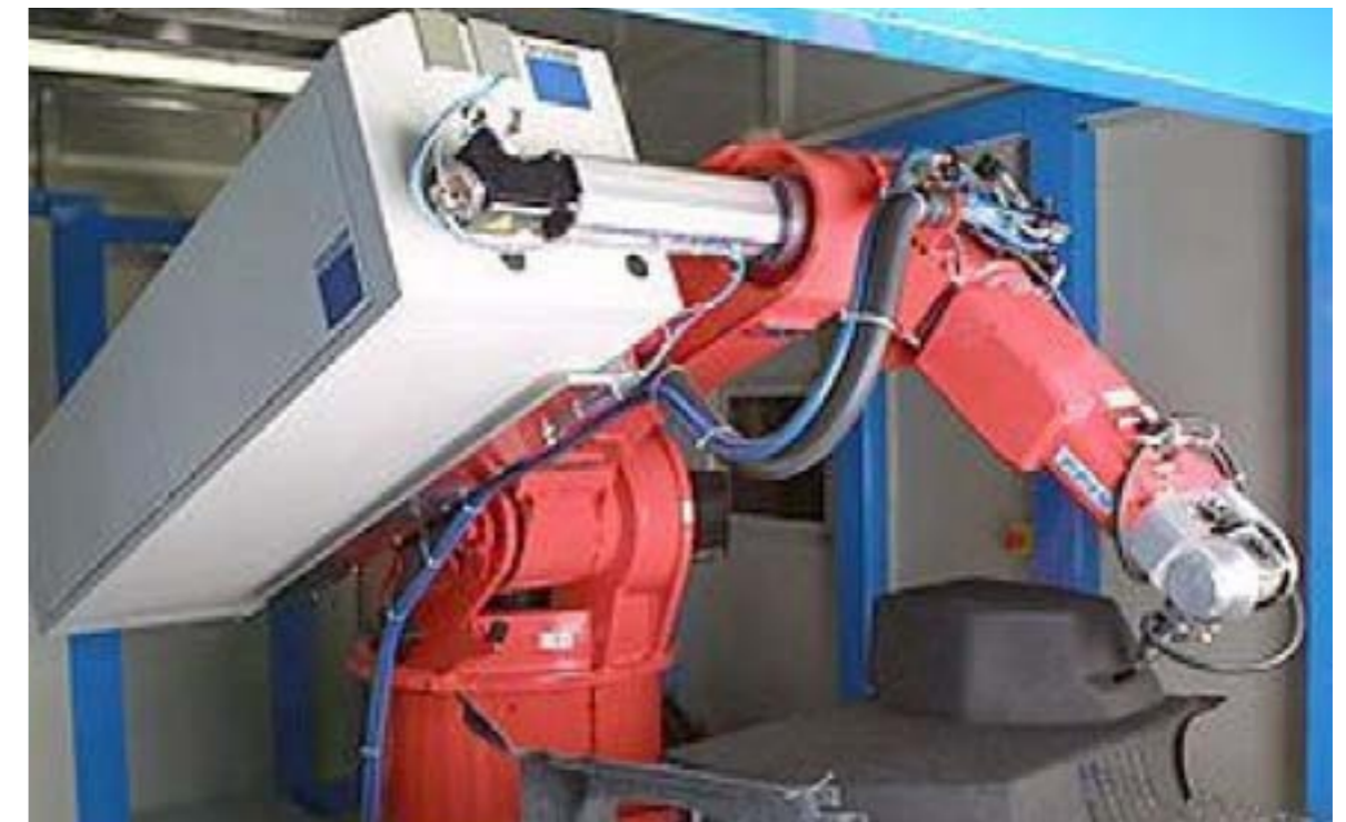
Rys. 4.8 Robot do napawania plazmowego [4], realizuje proces napawania elementów regenerowanych
