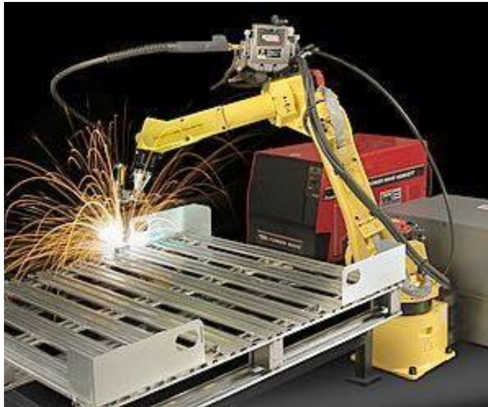
Rys.4.6 Robot spawalniczy [4], realizuje proces spawania lub proces cięcia wg zaprogramowanej trasy
