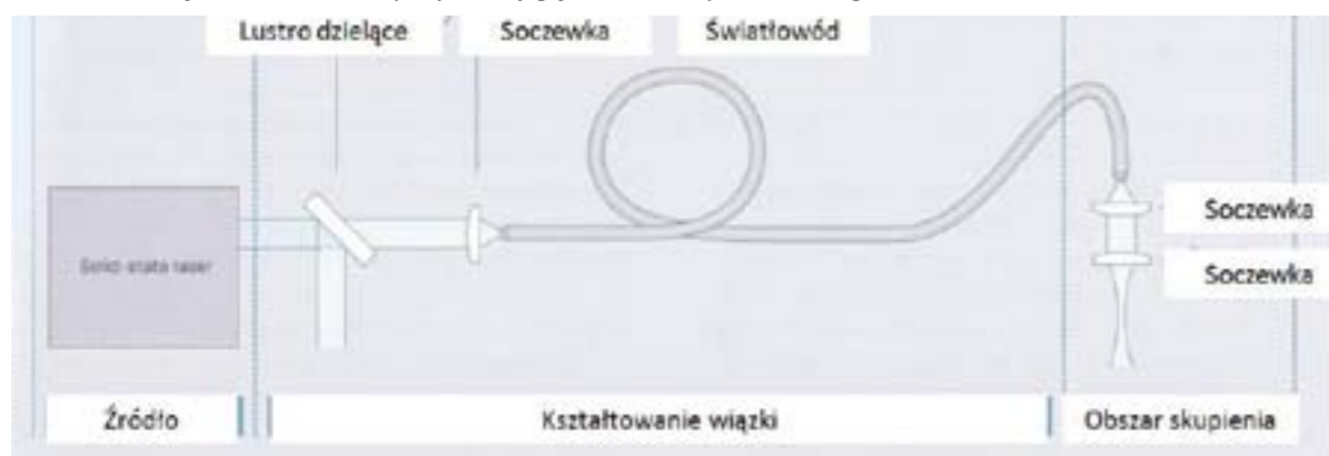
Rys. 7.21 Droga wiązki ze źródłem na ciało stałe
