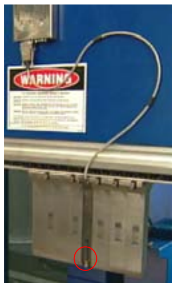
Rys. 6.63 Czujnik pomiaru kąta umieszczony w stemplu
