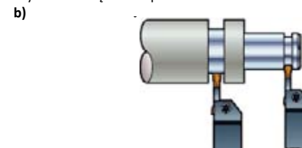
Rys. 5.7 Narzędzia do toczenia rowków i toczenia kanałków
