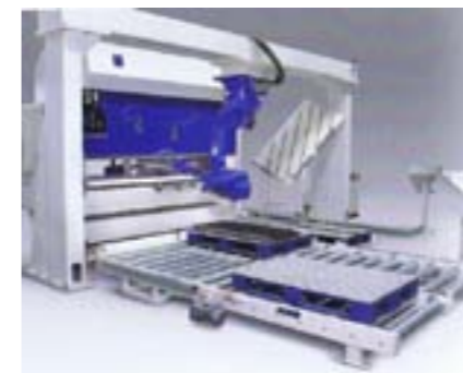
Rys. 6.14 Zautomatyzowane stanowisko do gięcia z podajnikiem rolkowy (z lewej)
