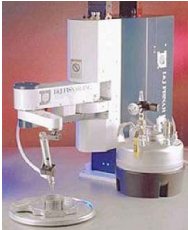
Rys.4.9 Robot pomiarowy [4], realizuje pomiary elementów, wizualizuje wyniki, sygnalizuje niezgodności z założonymi wartościami i archiwizuje wyniki pomiarów
