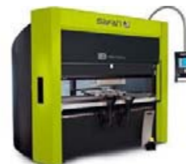
Rys. 6.18 Serwo-elektryczna prasa do gięcia (z lewej)
