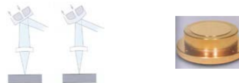
Rys. 7.22 Automatyczna regulacja ogniskowej z zastosowaniem lustra aktywnego (z lewej)
