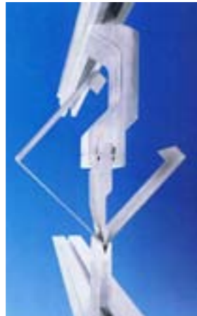
Rys. 6.51 Dobór narzędzi – specjalny uchwyt stempla
