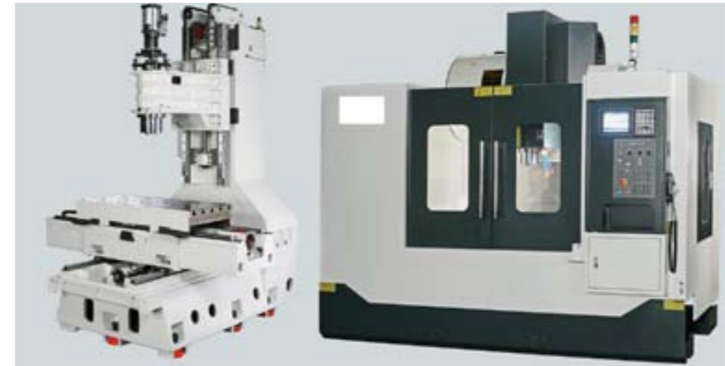
Rys. 4.2 Współczesna obrabiarka CNC bez osłon i z nałożonymi osłonami [11]
