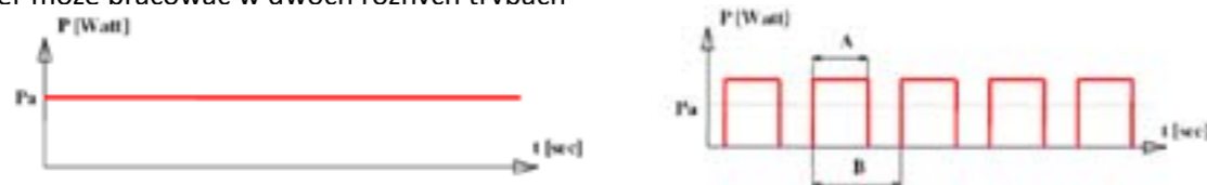
Rys. 7.38 Tryb ciągły pracy lasera CW (z lewej)
