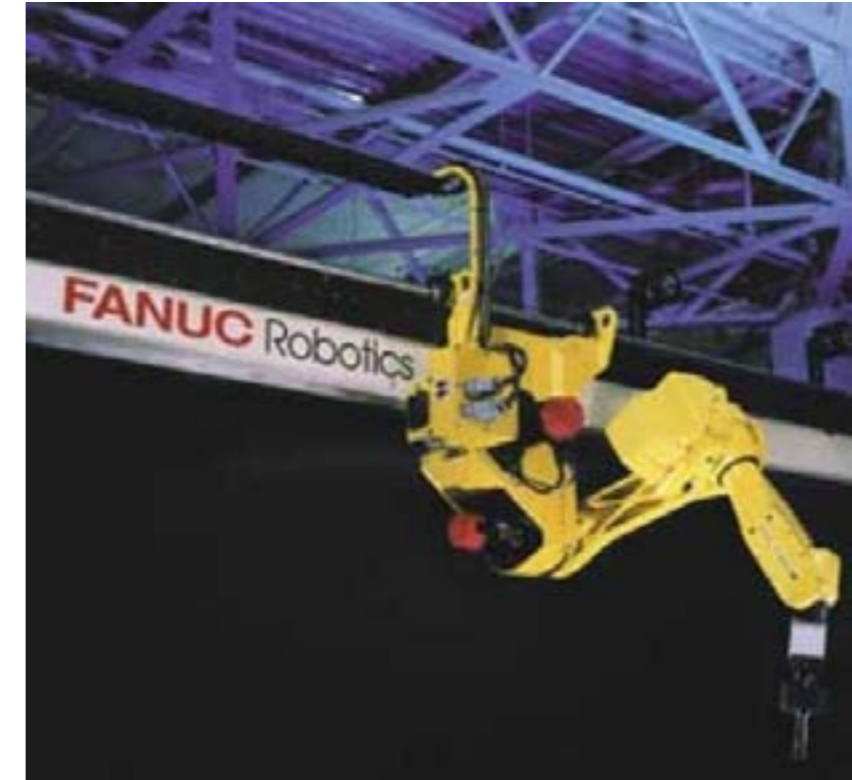
Rys.4.7 Robot transportowy [4], wyszukuje i dostarcza elementy na stanowiska linii produkcyjnej wg zadanego programu
