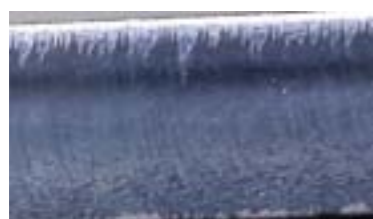
Rys. 7.50 Położenie ogniskowej zbyt niskie
