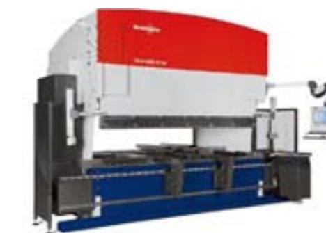
Rys. 6.17 Wielkogabarytowy tandem do gięcia dużych detali (z prawej)
