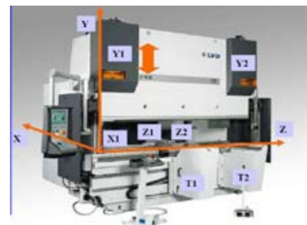
Rys. 6.21 Schemat osi w krawędziarce (z lewej)
