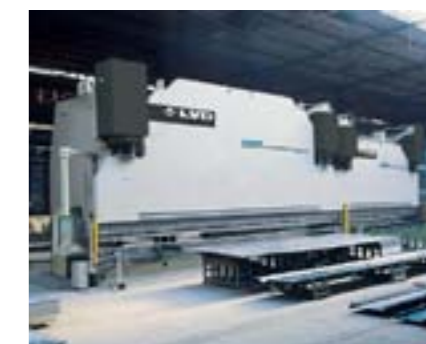
Rys. 6.17 Wielkogabarytowy tandem do gięcia dużych detali (z prawej)
