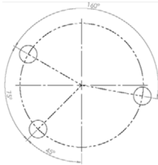
Rys.2.2 Wymiarowanie w układzie szeregowym a) we współrzędnych prostokątnych, b) we współrzędnych biegunowych.
