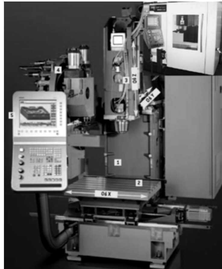
Rys. 2.1. Centrum frezarskie DMC 65 V (3 osie): 1– korpus żeliwny, 2 – stół roboczy, 3 – wrzeciono, 4 – magazyn narzędziowy, 5 – panel sterowania [3]
