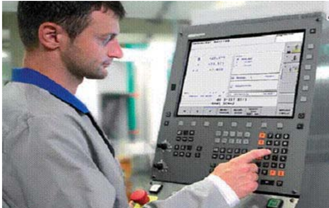
Rys. 9.31. Komputer wraz panelem sterowania oraz wyświetlaczem systemu serowania TNC 320 [TNC320 Die kompakte Bahnsteuerung für Fräs- und Bohrmaschinen]
