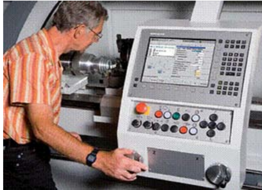
Rys. 9.33. Panel sterowania sytemu zintegrowany MANUALplus 620 z monitorem [MANUALplus 620 – Die Bahnsteuerung für Zyklen- und CNC-Drehmaschinen]
