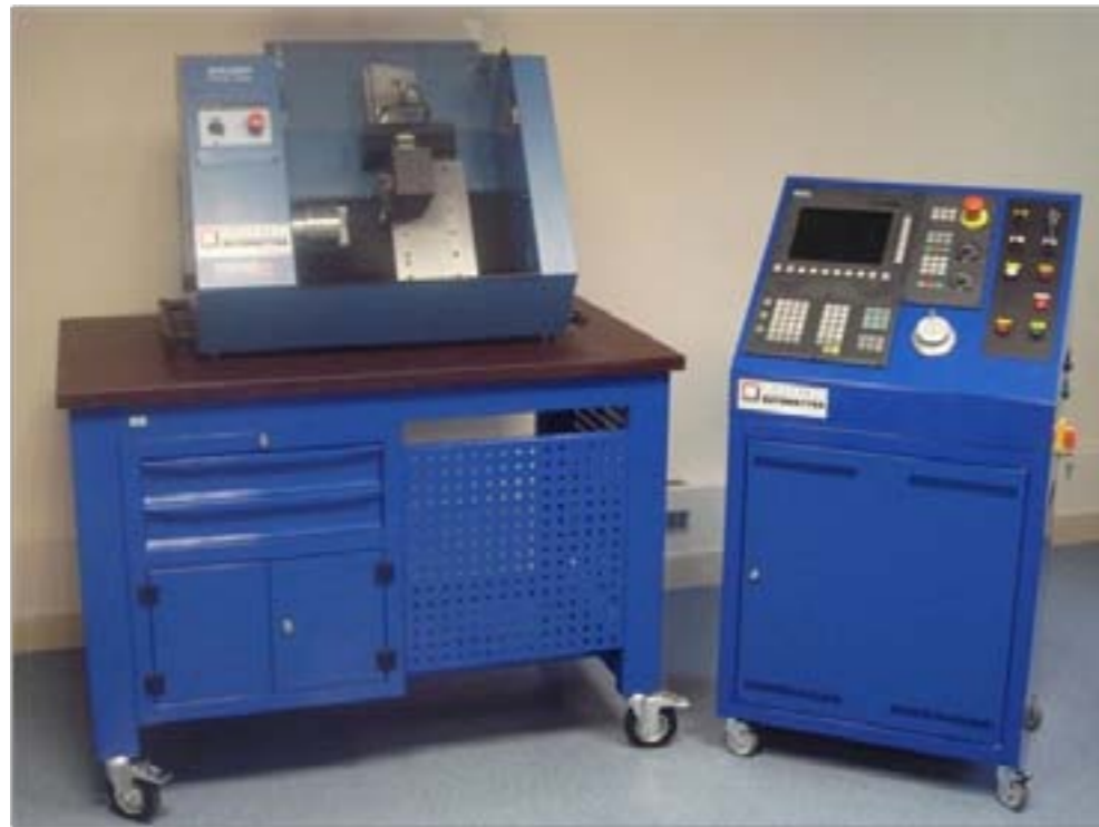
Rys.10.7. Edukacyjne tokarskie centrum obróbcze Plt3000 Plus . [http://www.tock.pl/obcnc.htm#plt300plus](http://www.tock.pl/obcnc.htm#plt300plus)(05.09.2011)
