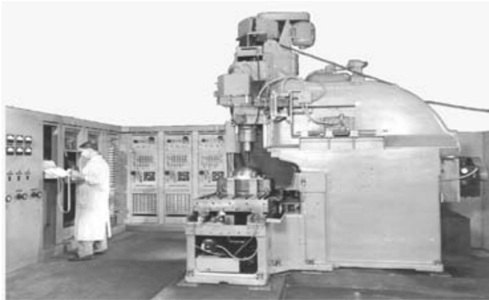
Rys. 9.1. Frezarka pionowa, wraz z urządzeniami sterującymi, zbudowana w MIT w 1953r (Nikiel, 2004)
