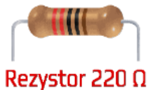
oznaczenie kodem barwnym rezystora 220 Ω - >
