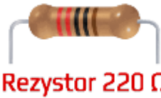
← oznaczenie kodem barwnym rezystora 220 Ω
