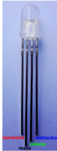
← opis wyprowadzeń diody RGB ze wspólną katodą
