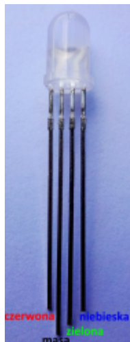
← opis wyprowadzeń diody RGB ze wspólną katodą
