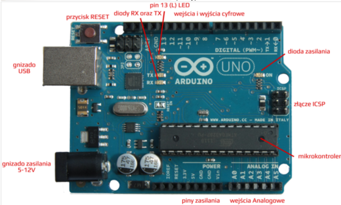
Opis wyprowadzeń Arduino UNO R3.
