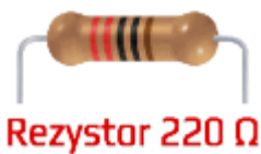
oznaczenie kodem barwnym rezystora 220 Ω →
