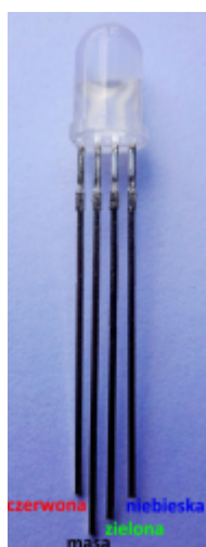
← opis wyprowadzeń diody RGB ze wspólną katodą
