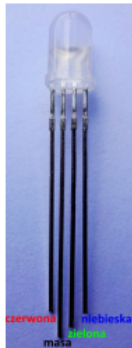
← opis wyprowadzeń diody RGB ze wspólną katodą
