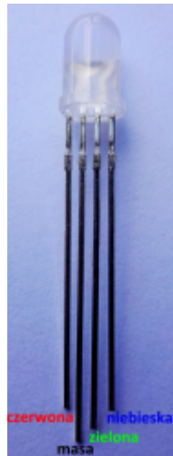
← opis wyprowadzeń diody RGB ze wspólną katodą
