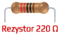
oznaczenie kodem barwnym rezystora 220 Ω
