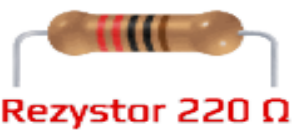
oznaczenie kodem barwnym rezystora 220 Ω
