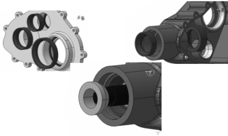
Rysunek 3.10. Symulacja poszczególnych operacji montażowych przekładni
