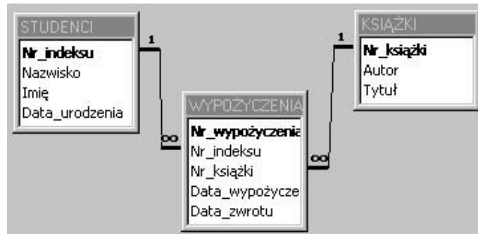
Rysunek 2.16. Przykład logicznej bazy danych uzyskanej ze schematu na rysunku 2.15
