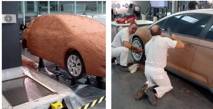
Rysunek 1.6. Wybrane dwa etapy projektowania kształtu nadwozia samochodu: frezowanie CNC na podstawie wirtualnego modelu (a), a następnie jego ręczne dopracowywanie i wykańczanie (b) [PSA]
