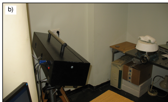
Rysunek 2.7. Model redukcyjny nadwozia wykonany przez studenta Wydziału Wzornictwa ASP w Warszawie Tomasza Pydo (a) ustawiony na stanowisku pomiarowym skanera 3D na Wydz. SiMR PW (b)
