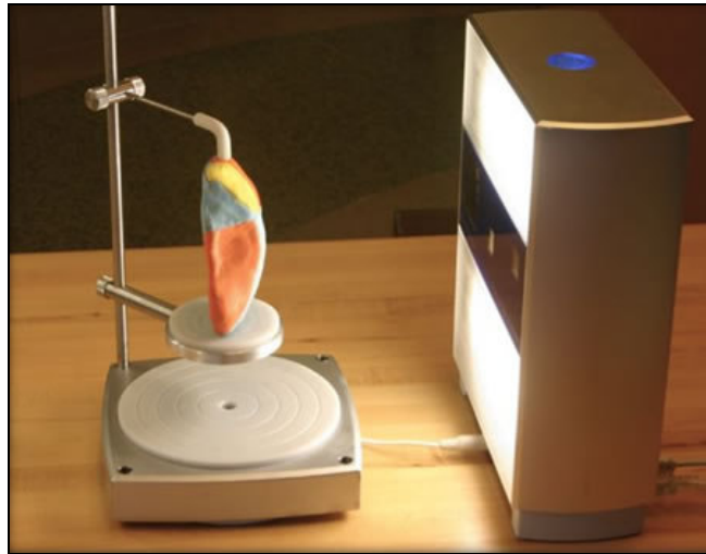
Rys. 4.6. Zestaw pomiarowy „Desktop 3D Scanner” firmy NextEngine podczas procesu skanowania (widoczne dwie jasne lampy oświetlające obiekt) [ http://think-twice-man.blogspot.com/ ]
