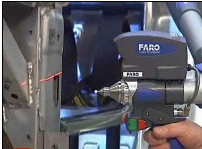
Rysunek 1.21. Pomiar konstrukcji spawanej pojazdu skanerem laserowym „Laser Scan Arm” firmy FARO. Widoczne jest na skanowanym obiekcie odbicie od linijki laserowej. [Faro]
