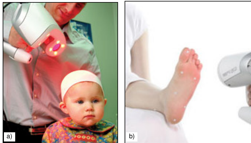
Rysunek 3.19. Pomiar czaszki dziecka w celu dopracowania kształtu miękkich skorup kasku (a) oraz skanowanie stopy w celu opracowania obuwia anatomicznego (b) [Asme]
