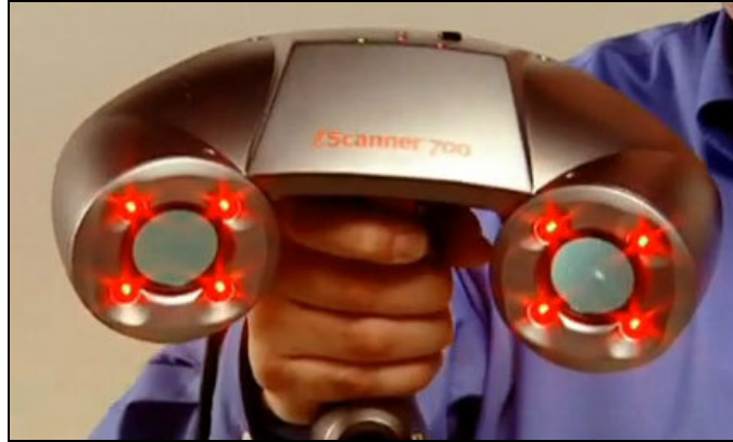
Rysunek 3.5. Włączone diody LED doświetlające obiekt mierzony. „ZScanner 700” firmy Z-Corporation [Z-Corp]
