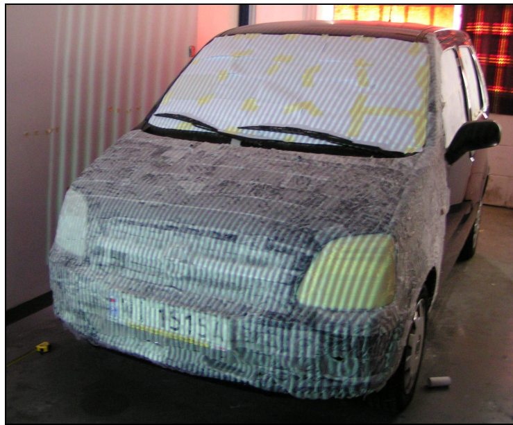
Rysunek 2.5. Widoczny raster na nadwoziu samochodu osobowego w postaci pionowych linii wygenerowanych przez skaner ScanBright [Król]
