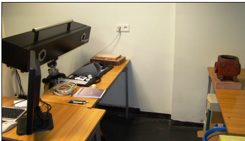
Rysunek 2.1. Skaner optyczny na światło białe nazwany „ScanBright” firmy Smarttech przygotowany do pomiaru korpusu przekładni na stanowisku Wydziału SiMR PW [Pabich]
