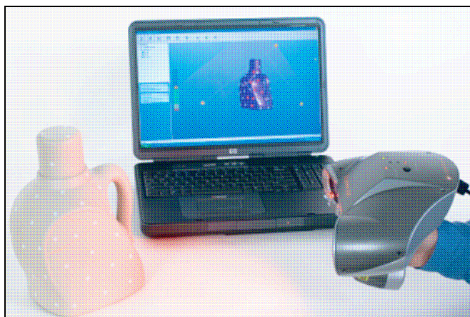
Rysunek 3.13. Przykład pomiaru makiety opakowania na płyn. Na ekranie komputera wyświetlana jest w czasie rzeczywistym skanowana powierzchnia. [Z-Corp]
