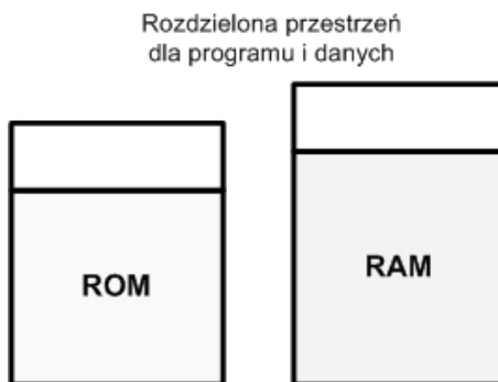
Rysunek 3.4. Model pamięci typu von Harvard
