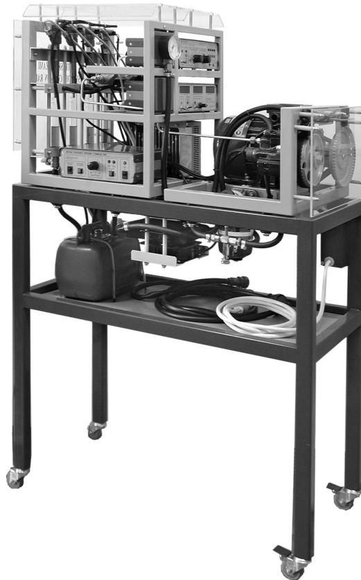
Rysunek 4.5. Zespół sterowania pompą i wtryskiwaczami systemu Common Rail
