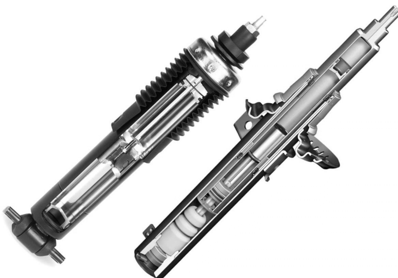
Rysunek 3.19. Amortyzator MagneRide™ (magnetoreologiczny)
