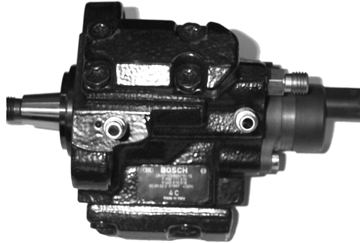
Rysunek 4.2. Pompa z regulatorem ciśnienia paliwa
