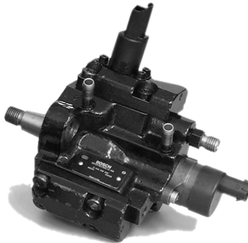
Rysunek 4.3. Pompa z elektromagnesem odłączającym jedną z sekcji
