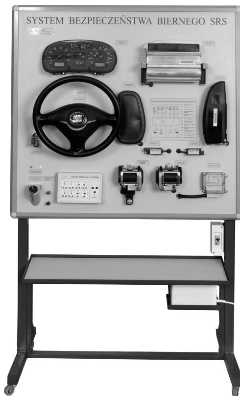
Rysunek 4.8. Układ bezpieczeństwa biernego SRS
