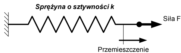
Rysunek 2.3. Sprężyna – magazyn energii
