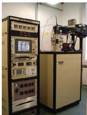
Reaktor CVD i diament wytworzony za jego pomocą
