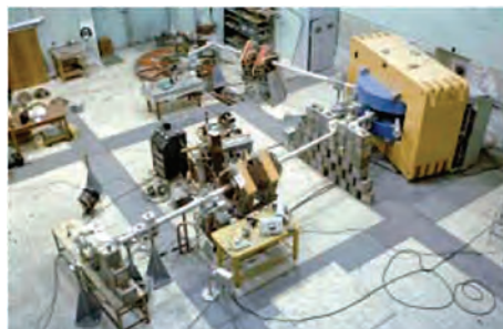
Rozbudowana hala eksperymentalna cyklotronu U-120 z wieloma liniami jonowymi (Lit.: Pół wieku krakowskiego cyklotronu U120, Adam Strzałkowski, FOTON 102, Jesień 2008)
