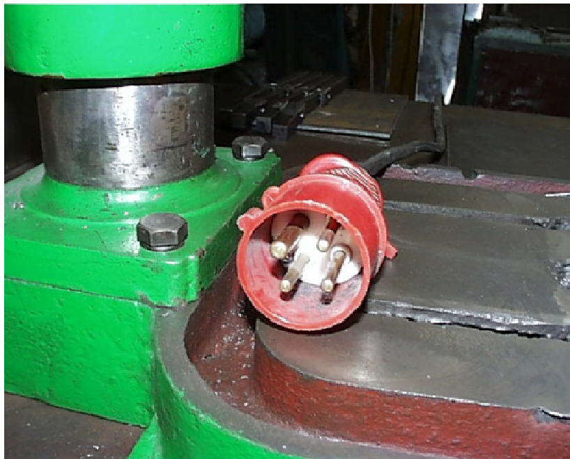
Rys. 9. Wiertarka elektryczna jako przykład odbiornika wykonanego w I klasie ochronności. Widoczna 5-stykowa wtyczka na sznurze zasilającym (styk ochronny wykonany jest jako bolec o średnicy większej, niż pozostałe).
