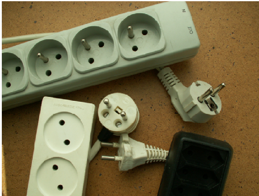
Rys. 11. Przykłady wtyczek i gniazd do zastosowań domowych. Klasy ochrony: 0 – białe (bez styku ochronnego), I – szare (ze stykiem ochronnym), II – wtyczka biała, gniazdo czarne (wtyczka może omijać styk ochronny gniazda o I klasie ochrony, gniazdo tu pokazane może przyjmować tylko wtyczkę płaską 2,5 A).
