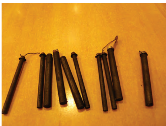
Fot. nr 4 Władysława Sikora, Społeczne Gimnazjum nr 7 – Wykorzystanie elektrod węglowych z baterii płaskich
