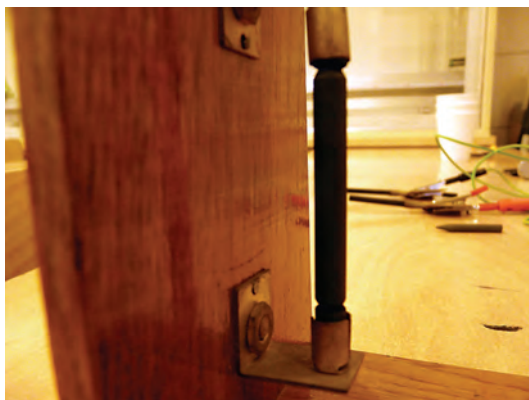
Fot. nr 2 Władysława Sikora, Społeczne Gimnazjum nr 7 – Zestaw doświadczalny – sposób montowania elektrod
