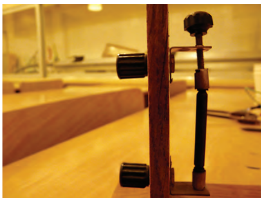
Fot. nr 3 Władysława Sikora, Społeczne Gimnazjum nr 7 – Zestaw doświadczalny – sposób regulowania odległości między elektrodami
