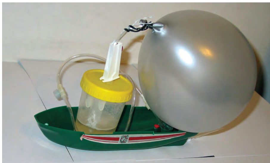
Fot.1. Kompletny model z napelnionym balonem. Pomiędzy balonem a reaktorem umieszczono zaciskacz.
