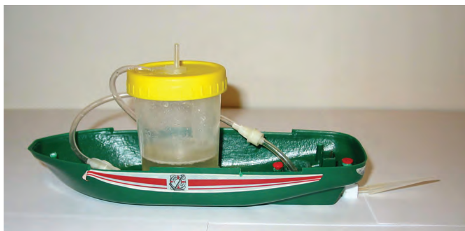
Fot.1. Kompletny model z napelnionym balonem. Pomiędzy balonem a reaktorem umieszczono zaciskacz.
