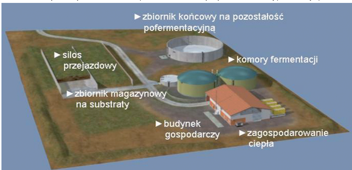
Rys. 73. Zagospodarowanie wybranych elementów w instalacji biogazowej
