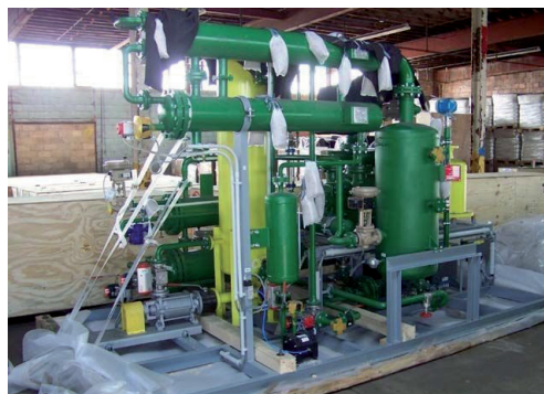
Rys. 52. Reaktor produkujący biodiesel
