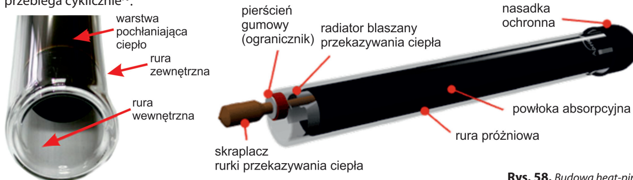
Rys. 58. Budowa heat-pipe
