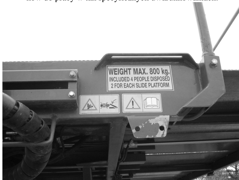
Rysunek 5.3. Nieprzeciążanie podestu, dobre przeszkolenie pracowników gwarancja bezpiecznej pracy.
