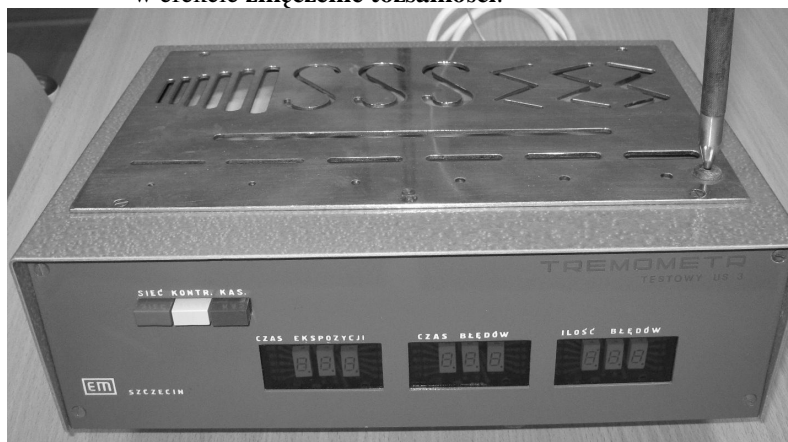
Rysunek 1.4 Aparat Tremometr - do pomiaru tremoru, precyzji ruchów, ruchów dowolnych ręki i koordynacji wzrokowo-ruchowej
