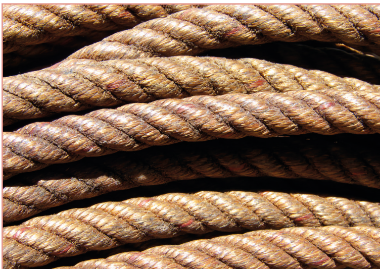
Rys. 6. Lina żeglarska wykonana z abaki
