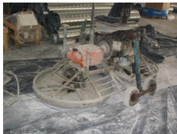
Rys.6.17. Maszyna do zacierania z założonym dyskiem do wstępnego zatarcia. Źródło własne
