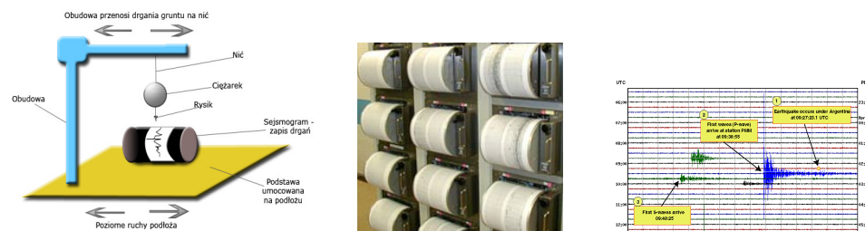
Rys. 8. a) Zasada budowy sejsmografu i widok rzeczywisty baterii b) sejsmogram.
