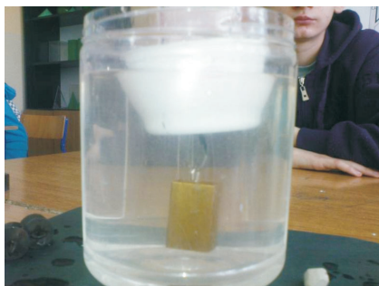
Mniejsze zanurzenie łódki z podwieszonym ciężarkiem
