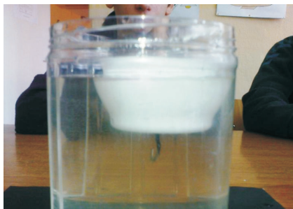
Duże zanurzenie łódki z ciężarkiem wewnątrz
