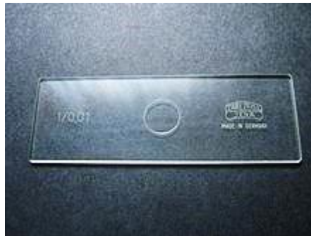
Rys. 1. Szkiełko kalibracyjne zwane szkiełkiem mikrometrycznym lub mikrometrem obiektywowym
