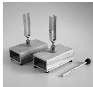
Rys. 3. Kamerton z pudłem rezonansowym
