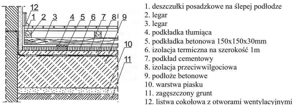
Rys. nr 9. Konstrukcja sprężystej podłogi w szkolnych salach gimnastycznych- z deszczulek na ślepej podłodze 4
