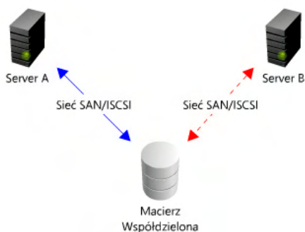
Rys. 5.1. Klastr zbudowany z dwóch węzłów oparty o macierz współdzieloną.
