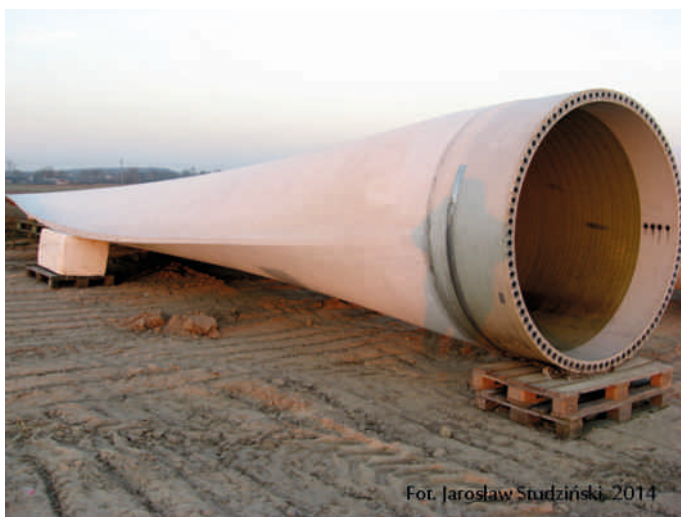
Łopata wirnika elektrowni (śmigło wiatraka), długość 39 m
