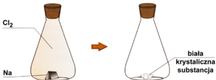
Rys. 2. Reakcja chloru z sodem
