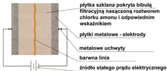
Rys. 3. Schemat zestawu do badania wędrówki jonów w polu elektrycznym
