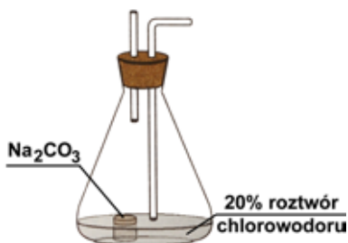
Rys. 2. Oznaczanie zawartości węgla na podstawie pomiaru ubytku masy na skutek działania kwasu
