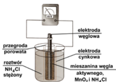
Rys. 1. Schemat ogniwa Leclanchého
