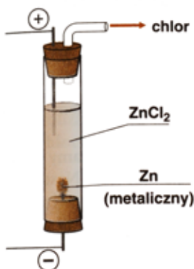
Rys. 11. Zestaw do elektrolizy wodnego roztworu chlorku cynku
