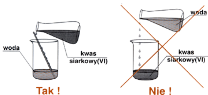
Rys. 36. Prawidłowy i nieprawidłowy sposób rozcieńczania kwasu siarkowego(VI) wodą
