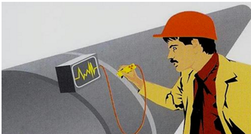
Rysunek 3.111: Badanie defektoskopowe rurociągu
