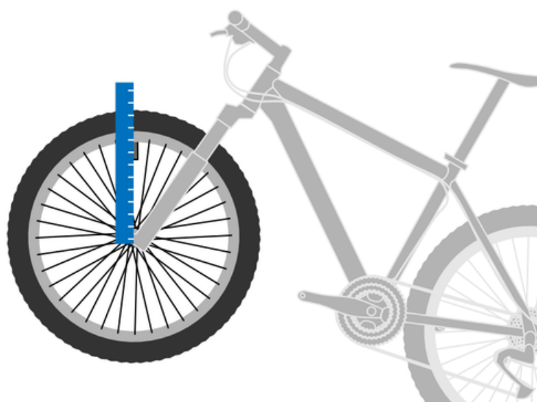
Rysunek 1.36: Pomiar promienia r okręgu, po którym porusza się wentyl
