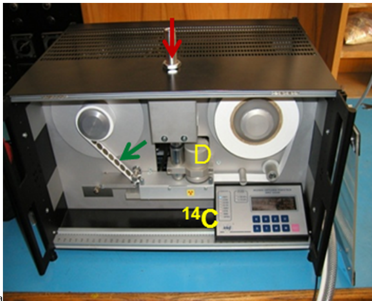
Rysunek 3.114: Izotopowy Miernik Zapylenia Powietrza AMIZ produkowany w Instytucie Chemii i Techniki Jądrowej
