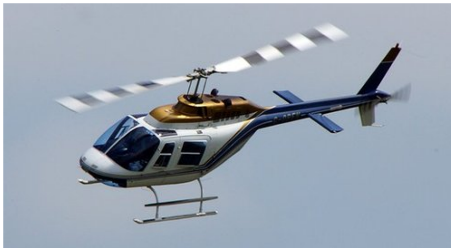
Rysunek 4.38: Dodatkowe śmigło na ogonie przeciwdziała obracaniu się kadłuba helikoptera
