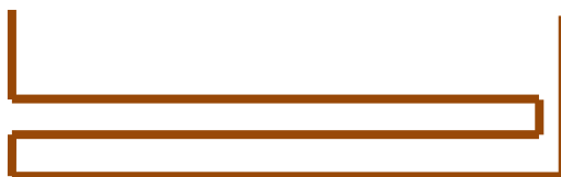
Rysunek 3. Model ramki z większą liczbą poziomych elementów ułatwiający pomiar zmiany ciężaru spowodowanego działaniem siły elektrodynamicznej.
