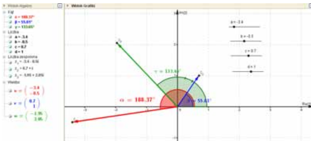
Rys. 9.4 - Geometryczna interpretacja mnożenia liczb zespolonych.
