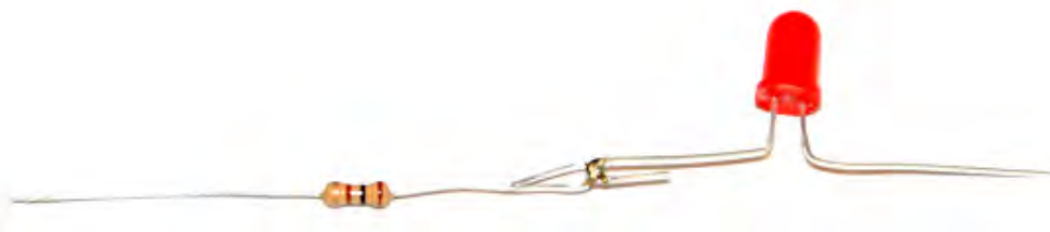
Rys 3 Zlutowana dioda i rezystor
