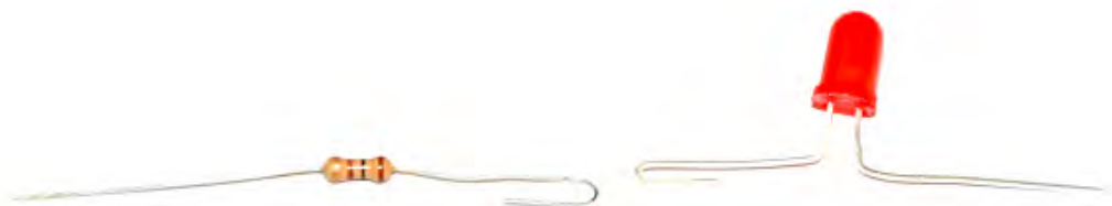
Rys 2 Dioda i rezystor przygotowane do lutowania
