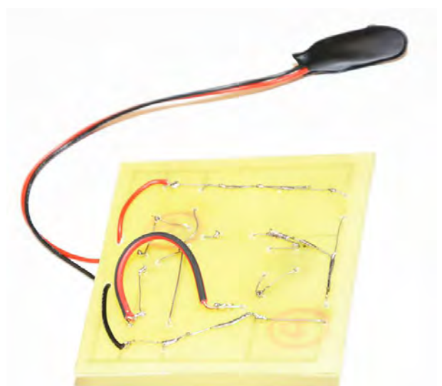
Rys 61 Gotowy układ – widok od strony połączeń
