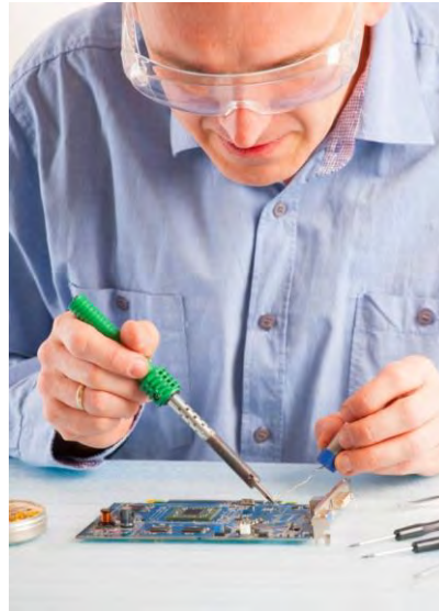
Rys 15 Sposób, w jaki należy trzymać lutownicę i spoiwo
