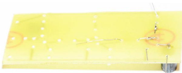
Rys 68 Pierwszy moduł – widok od strony połączeń
