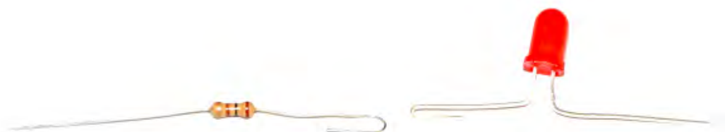
Rys 18 Dioda i rezystor przygotowane do lutowania
