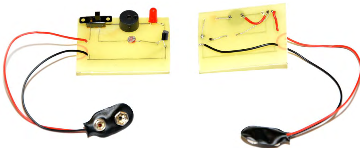
Rys 39 Gotowy układ „Alarm”, widok z obu stron
