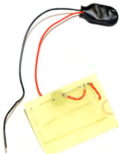
Rys 38 Sposób połączenia włącznika
