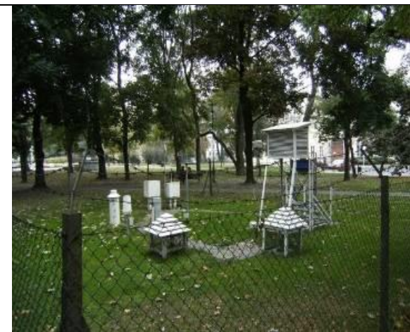
Rozplanowanie przyrządów, ogrodzenie
